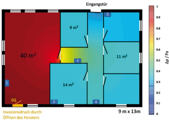
Abb. 2: Berechnete räumliche Verteilung der Druckerhöhung  $\Delta p$  in einer Wohnung zum Zeitpunkt 0,18 s nach dem Öffnen des Fensters SQ. Die Berechnung verdeutlicht, dass die kurzzeitige Druckerhöhung ( $\Delta p > 0$ ), verursacht durch das Öffnen des Fensters, sich auf alle Räume ausbreitet.
