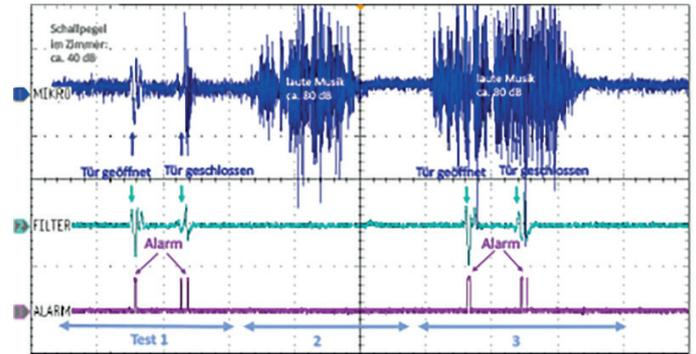
Abb. 3: Die Grafik zeigt den zeitlichen Verlauf der gemessenen Signale von Detektor („Mikro“, blau), nach der elektronischen Signalfilterung („Filter“, grün) und das Alarm-Triggersignal („Alarm“, lila). Es sind drei unterschiedliche Szenarien aufgeführt, die verdeutlichen, dass nur das Öffnen bzw. Schließen einer Tür / eines Fensters aufgrund deren charakteristischer Infraschallwelle zum Auslösen des Alarms führt, laute Sprache oder Musik hingegen nicht.
